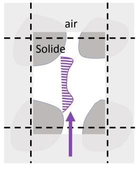
Ecoulement visco-inertiel sous gradient de pression
